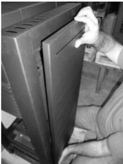
Figura 11 – Montagem das capas laterais
