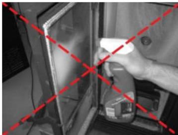
Figura 54 – Limpeza incorrecta do vidro
