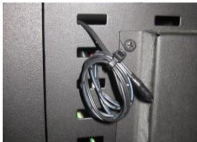
Figura 20 – Sonda de temperatura ambiente
