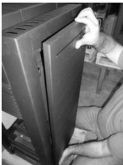
Figura 24 – remoção das capas laterais
